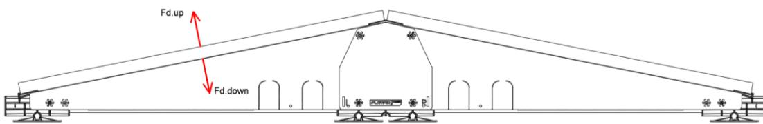
Les composantes horizontales des forces perpendiculaires (F) sont utilisées pour la détermination de la résistance au glissement du système.
