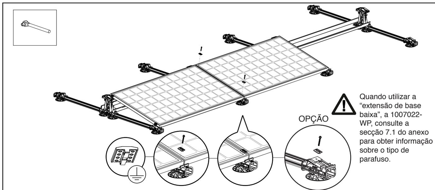
Coloque o último módulo fotovoltaico da fileira nas bases para que esteja entre as saliências verticais. Agora aperte o parafuso de montagem com um grampo modular nos orifícios de montagem das bases. Agora fixe os dois grampos terminais com o parafuso no furo de montagem. Assegure-se de que os módulos fotovoltaicos estejam completamente retos antes de apertar o parafuso!
