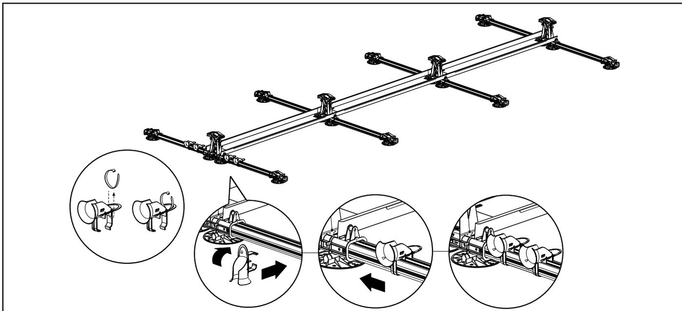
1. Introduza todos os cabos (+) através do 1.º guia de saída do cabo e todos os cabos (-) através do 2.º guia de saída do cabo. Prenda os cabos nas guias de saída do cabo com abraçadeiras para evitar que se movam.
