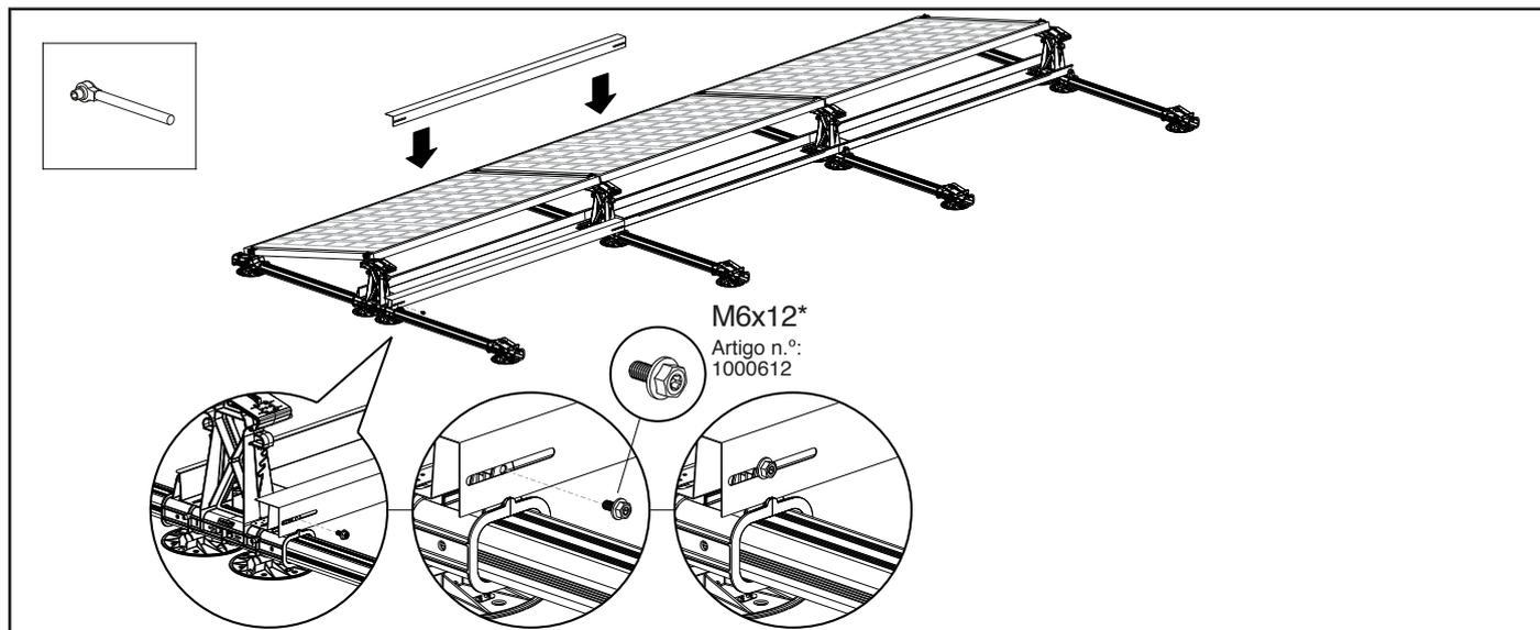
\*A Esdec testou e aprovou o parafuso métrico M6 x 12 para fixar o estabilizador à base alta de plástico.
