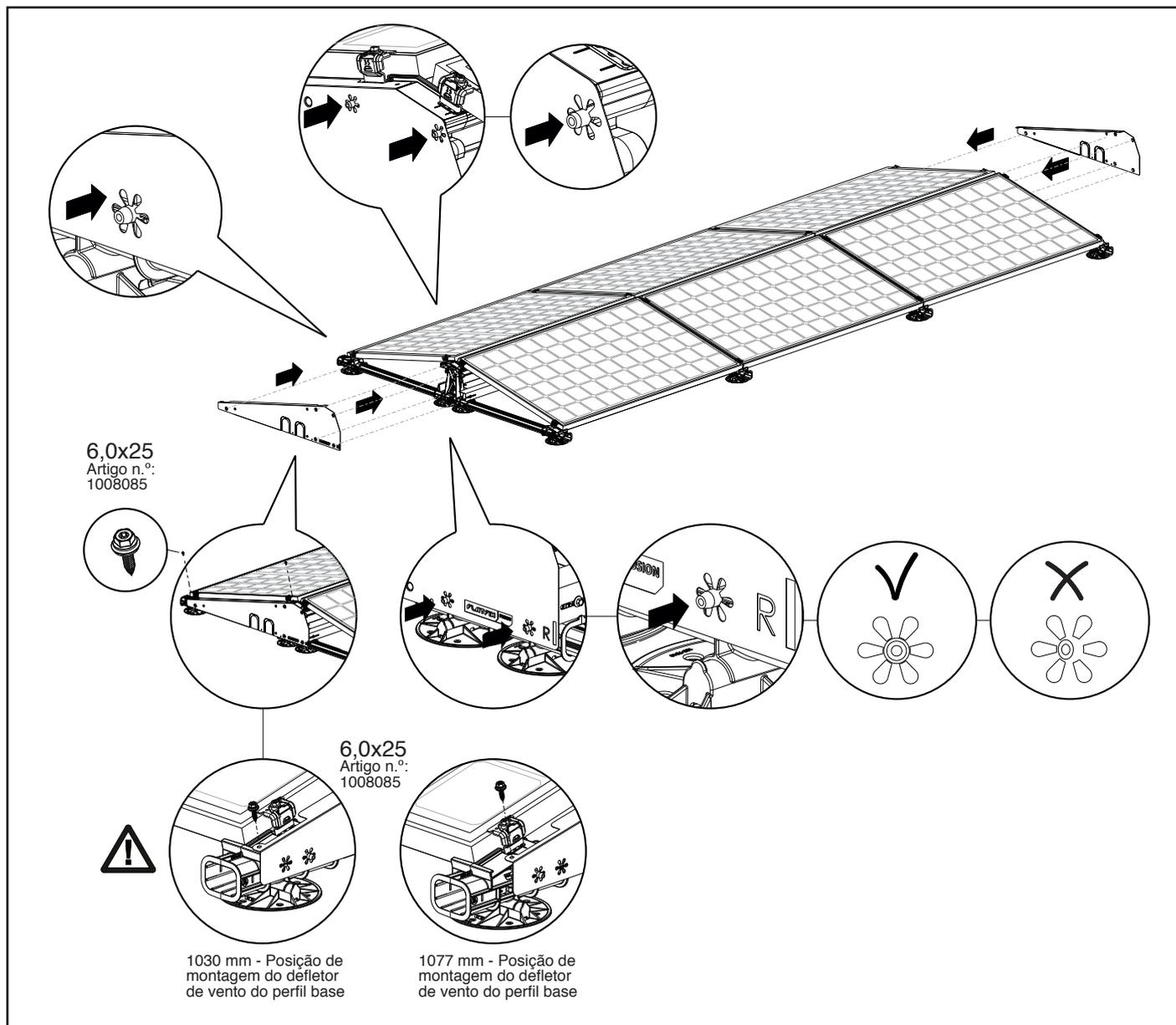
**NOTA!** Se estiver a utilizar o perfil base de 1030 mm (Artigo n.º 1007195) ou o perfil base de 1077 mm (Artigo n.º 1007196), preste atenção ao posicionamento dos defletores de vento à esquerda (Artigo n.º 1007226(- B)) e à direita (Artigo n.º 1007227(-B)) no perfil base. Use o starlock adequado e fixe os defletores de vento no lugar com o parafuso de chapa auto-roscante 6,0 x 25 mm SW10 HEX/T30 (Artigo n.º 1008085).
