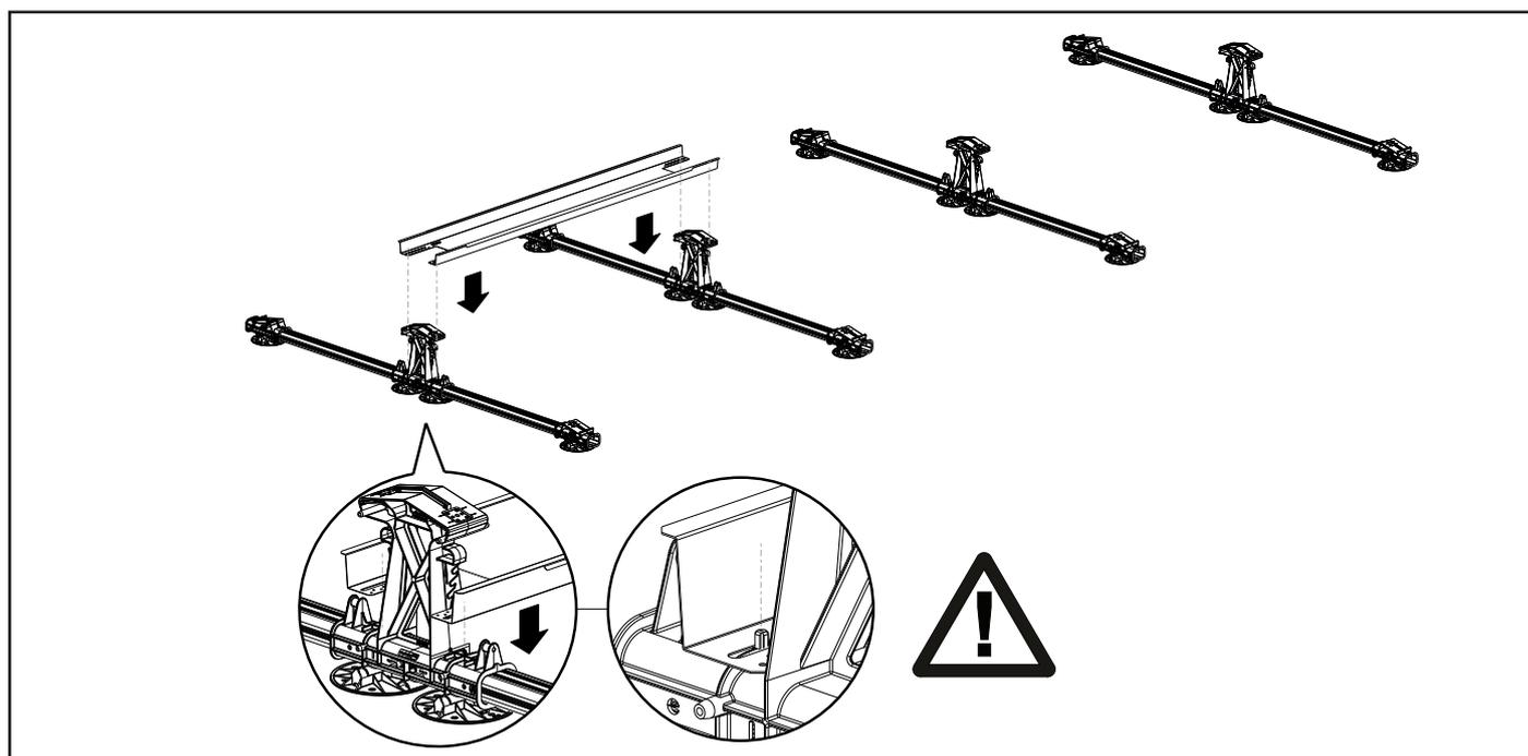
Coloque o segundo tabuleiro de lastro entre os segmentos do FlatFix Fusion de tal modo que sobreponha o primeiro tabuleiro de lastro e as ranhuras do tabuleiro de lastro sejam posicionadas sobre as saliências verticais da base alta.
