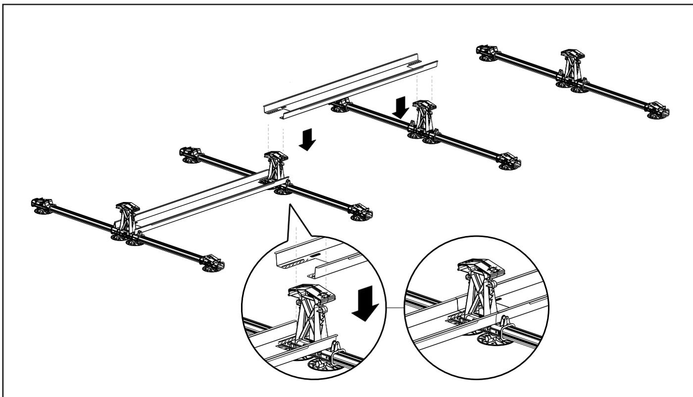
Coloque o terceiro tabuleiro de lastro entre os segmentos do FlatFix Fusion para que sobreponha o segundo tabuleiro de lastro e as ranhuras do tabuleiro de lastro estejam posicionadas sobre as saliências verticais da base alta. Repita estes passos até que estejam instalados todos os tabuleiros de lastro.
