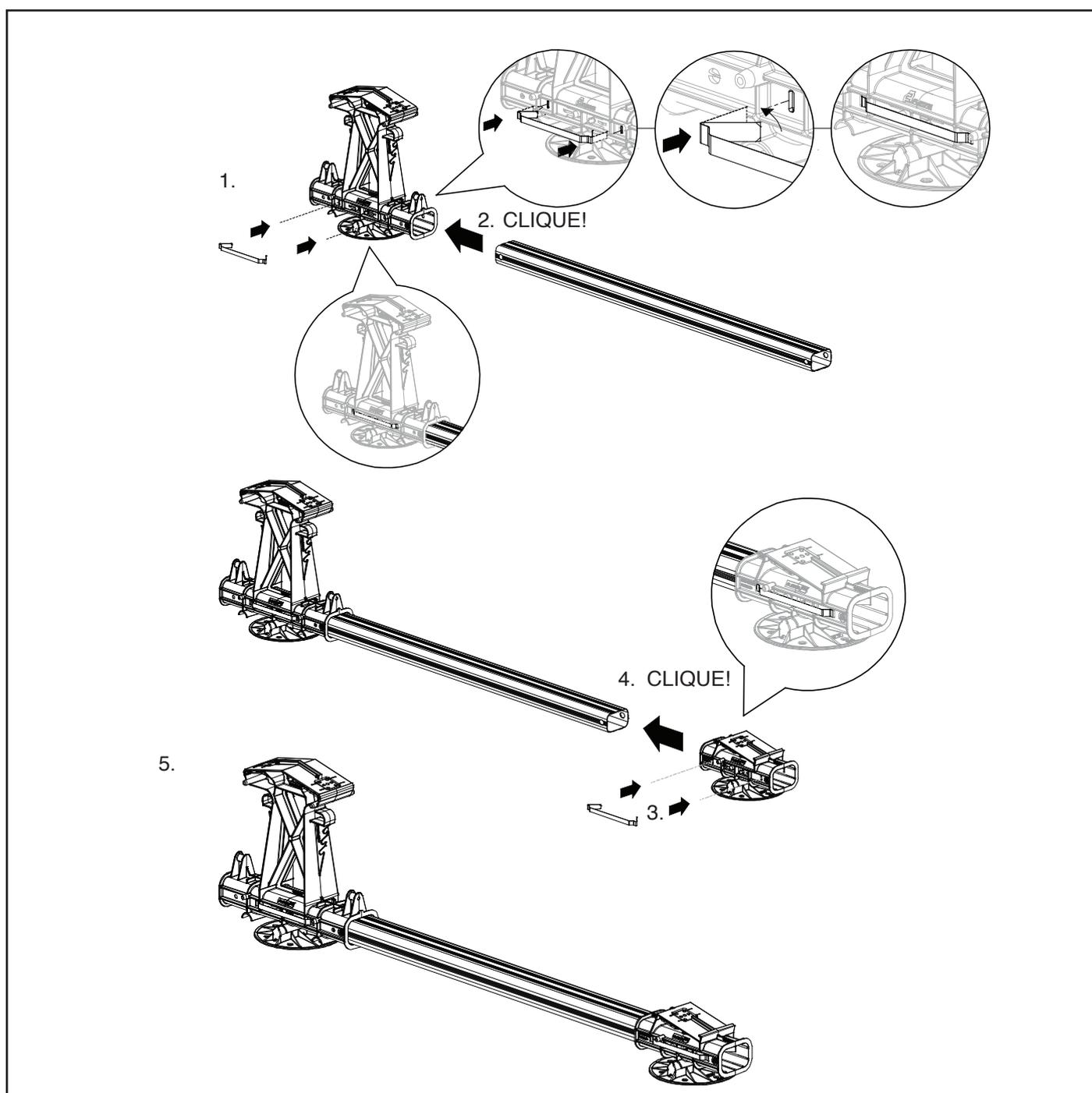
6. Deslize a extremidade do 2.º perfil base na abertura da base alta até encaixar no lugar com um clique.
