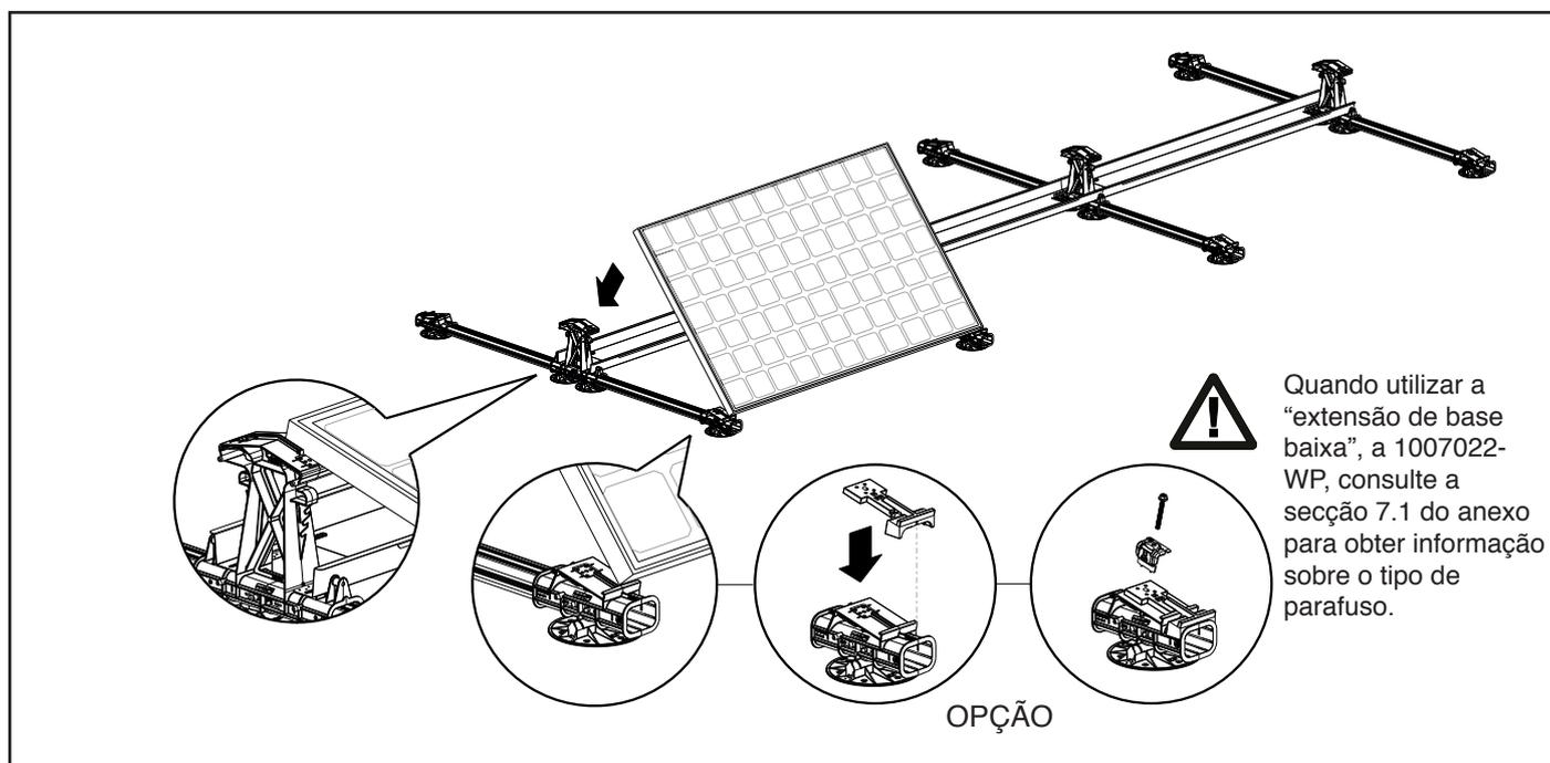
3. Coloque os grampos terminais na borda do módulo fotovoltaico e posicione-os nos orifícios de montagem nas bases baixa e alta. Aparafuse o grampo terminal com o parafuso de montagem no furo de montagem.
