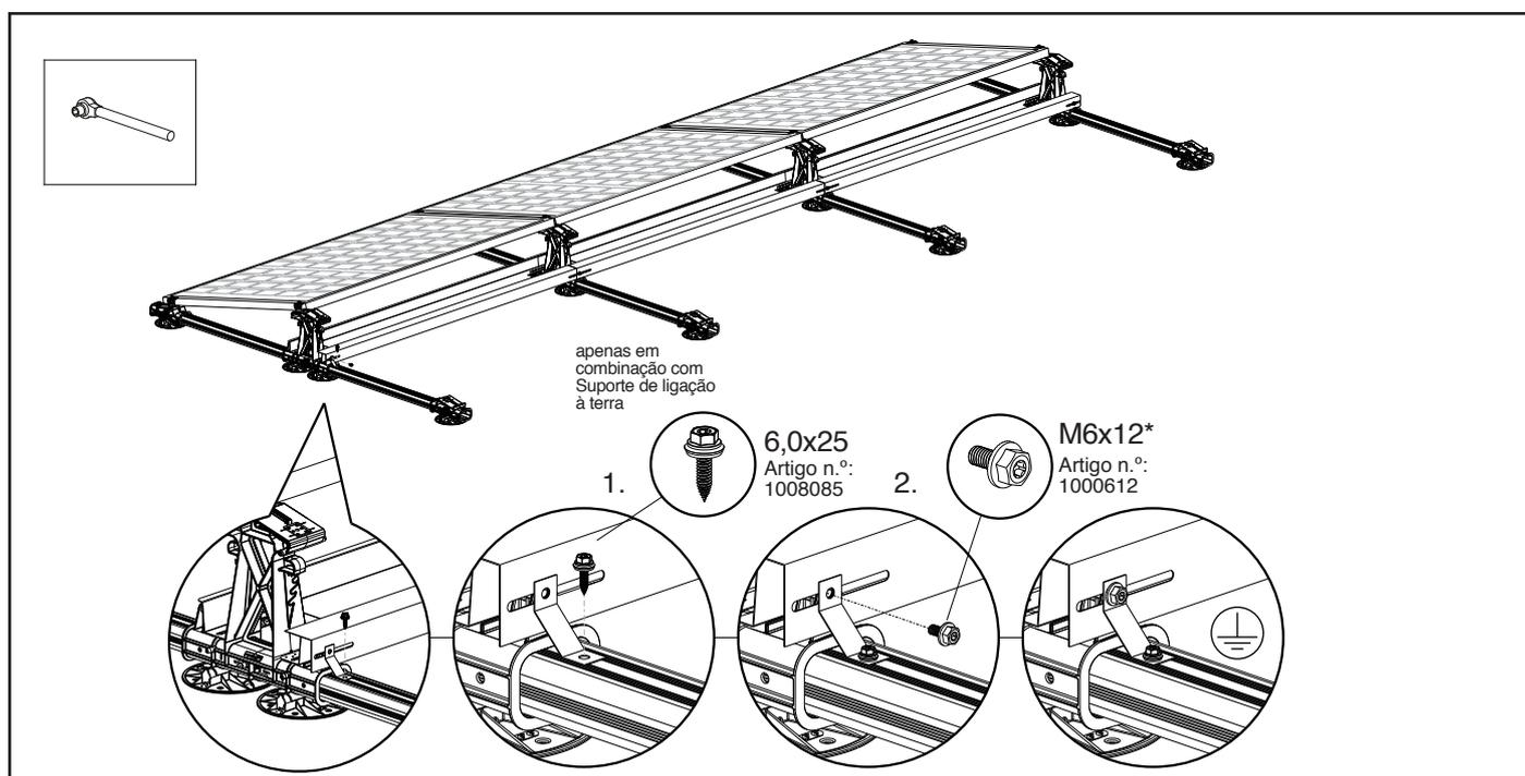
\*A Esdec testou e aprovou o parafuso métrico M6 x 12 para fixar o estabilizador à base alta de plástico.
