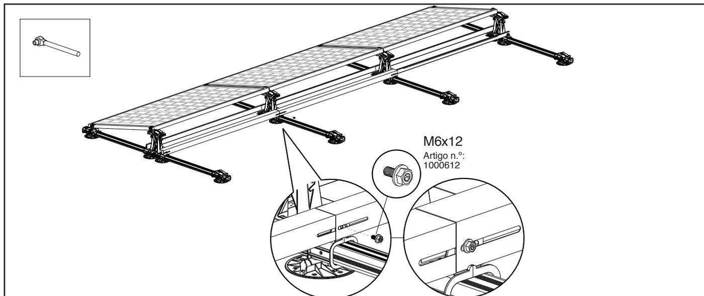
Coloque o último estabilizador na parte traseira dos módulos fotovoltaicos de modo que a extremidade inferior do estabilizador fique entre as saliências verticais das bases altas e as ranhuras dos estabilizadores, e os orifícios dos parafusos das bases altas fiquem sobrepostos.
