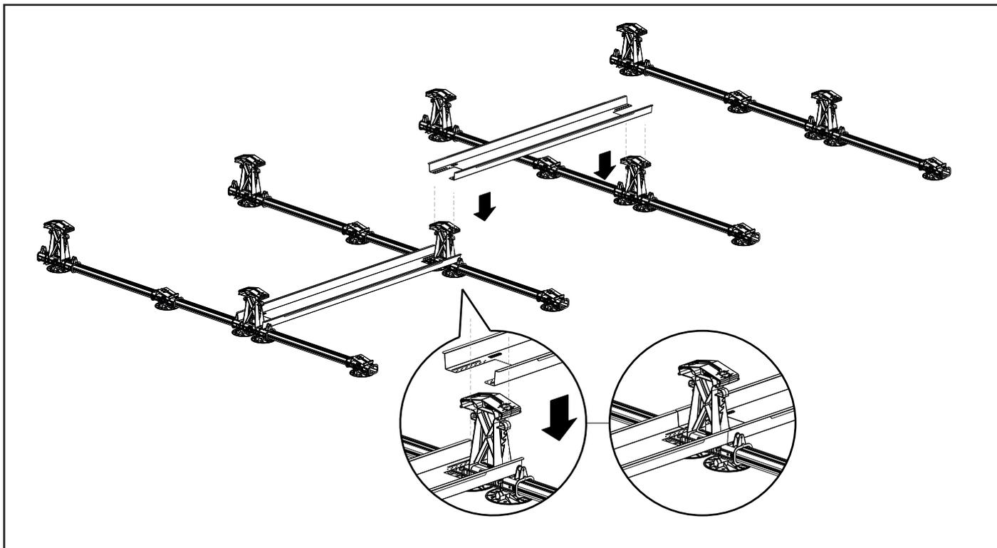
Coloque o terceiro tabuleiro de lastro entre os segmentos do FlatFix Fusion para que sobreponha o segundo tabuleiro de lastro e as ranhuras do tabuleiro de lastro estejam posicionadas sobre as saliências verticais da base alta. Repita estes passos até que estejam instalados todos os tabuleiros de lastro.
