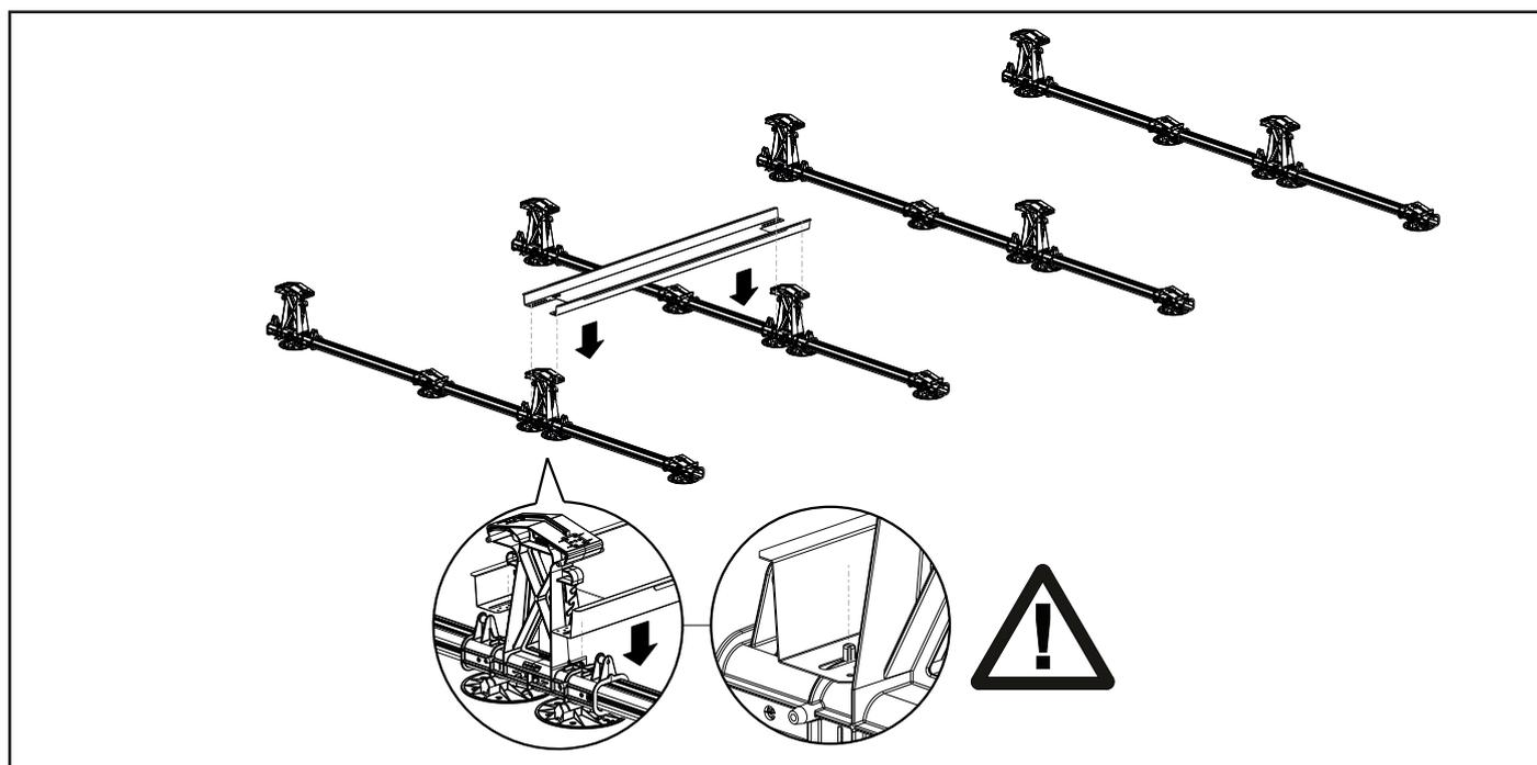
Coloque o segundo tabuleiro de lastro entre os segmentos do FlatFix Fusion para que sobreponha o primeiro tabuleiro de lastro e as ranhuras do tabuleiro de lastro estejam posicionadas sobre as saliências verticais da base alta.
