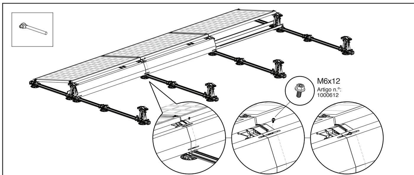
Coloque o último defletor de vento na parte traseira dos módulos fotovoltaicos de modo que a extremidade inferior do defletor de vento fique entre as saliências verticais das bases altas e as ranhuras dos defletores de vento, e os orifícios dos parafusos das bases altas fiquem sobrepostos.
