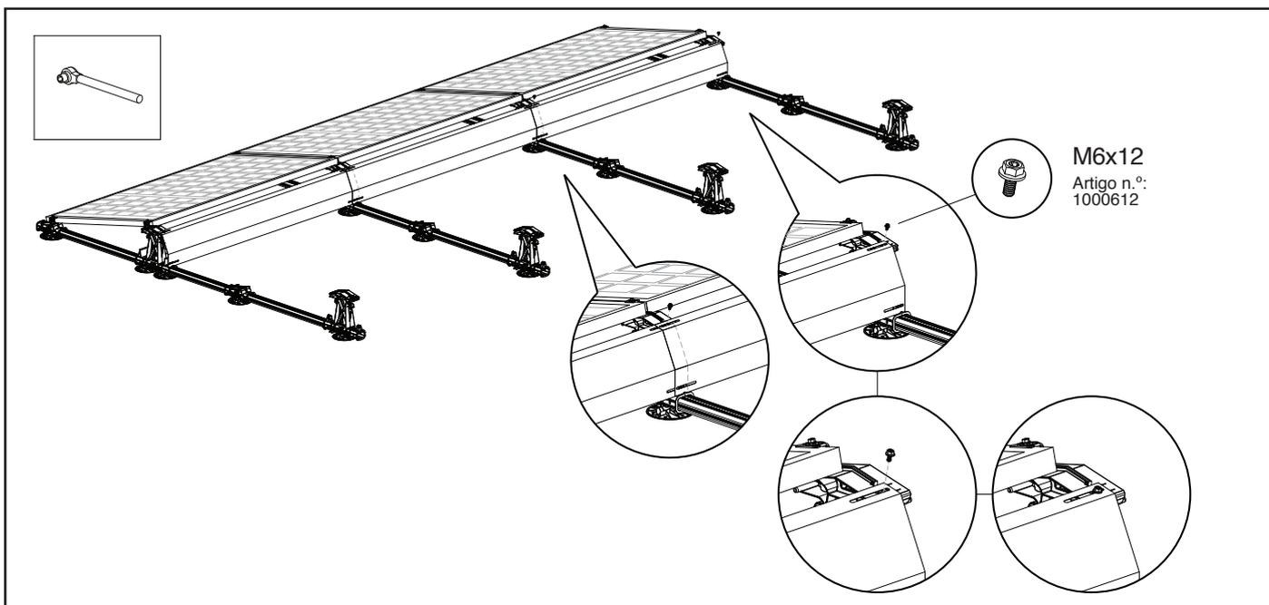
Encaixe os defletores de vento (nos dois lados) nas bases altas colocando o parafuso de montagem M6x12 nas ranhuras do defletor de vento e aparafuse-o nos orifícios de montagem das bases altas. **NOTA!** O binário de aperto máximo das ligações aparafusadas é de 2 Nm. Assegure-se de que os parafusos de montagem não deslizem na base. Consulte o seu manual de ferramentas para o ajustar ao binário correto.
