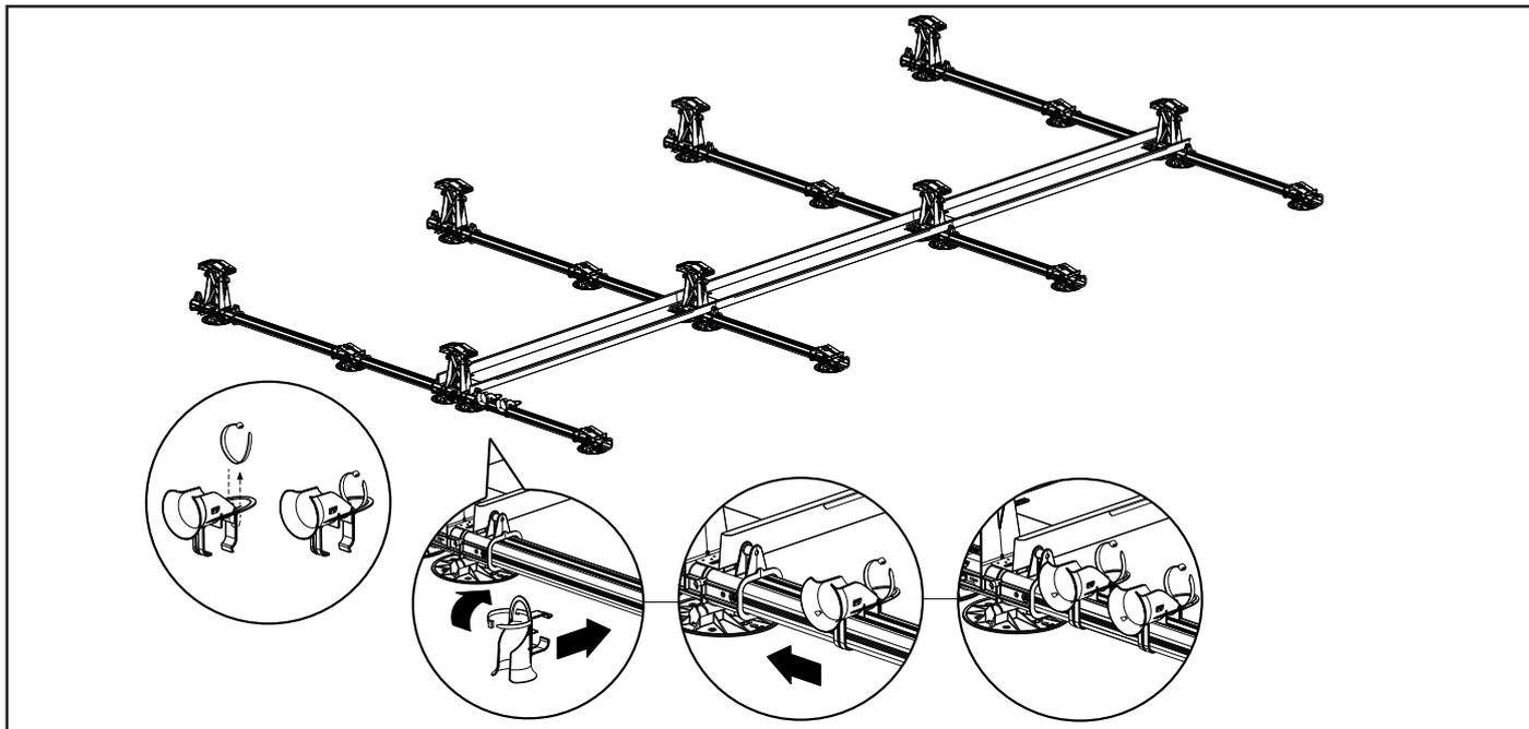
1. Introduza todos os cabos (+) através do 1.º guia de saída do cabo e todos os cabos (-) através do 2.º guia de saída do cabo. Prenda os cabos nas guias de saída do cabo com abraçadeiras para evitar que se movam.
