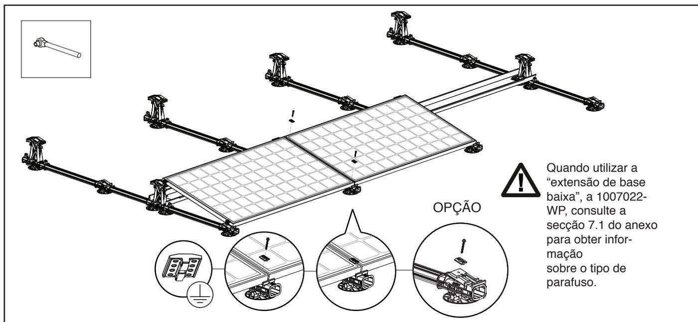
Coloque o último módulo fotovoltaico da fileira nas bases para que esteja entre as saliências verticais. Agora aperte o parafuso de montagem com um grampo modular nos orifícios de montagem das bases. Agora fixe os dois grampos terminais com o parafuso no furo de montagem. Assegure-se de que os módulos fotovoltaicos estejam completamente retos antes de apertar o parafuso!
