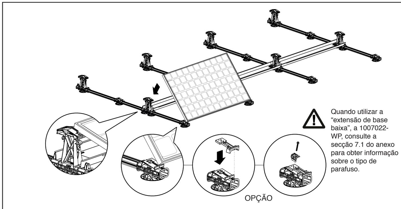
3. Coloque os grampos terminais na borda do módulo fotovoltaico e posicione-os nos orifícios de montagem nas bases baixa e alta. Aparafuse o grampo terminal com o parafuso de montagem no furo de montagem.
