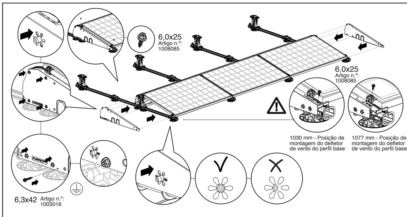
**NOTA!** Se estiver a utilizar o perfil base de 1030 mm (Artigo n.º 1007195) ou o perfil base de 1077 mm (Artigo n.º 1007196), preste atenção ao posicionamento dos defletores de vento à esquerda (Artigo n.º 1007226(-B)) e à direita (Artigo n.º 1007227(-B)) no perfil base. Use o starlock adequado e fixe os defletores de vento no lugar com o parafuso de chapa auto-roscante 6,0 x 25 mm SW10 HEX/T30 (Artigo n.º 1008085).
